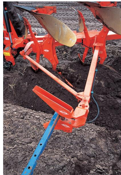
Доступный для всего спектра плугов, данный кронштейн и позволяет проводить вспашку с прикатыванием (т.к. установить каток). На крючкообразной части кронштейна, где существует наибольший риск повреждения, все ниппели для смазки и гидравлические трубы защищены, поскольку находятся внутри конструкции. Кронштейн легко складывается в транспортное положение.
