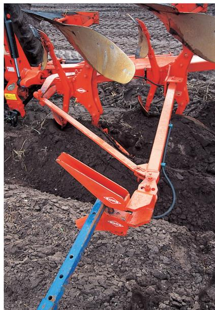
Доступный для всего спектра плугов, данный кронштейн и позволяет проводить вспашку с прикатыванием (т.к. установить каток). На крючкообразной части кронштейна, где существует наибольший риск повреждения, все ниппели для смазки и гидравлические трубки защищены, поскольку находятся внутри конструкции. Кронштейн легко складывается в транспортное положение.
